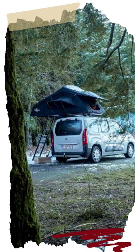
Il est important de rappeler que la tente repose sur des barres de toit qui sont fixées sur le châssis du véhicule. À aucun moment la tente ne repose sur le toit de la voiture en lui-même.
